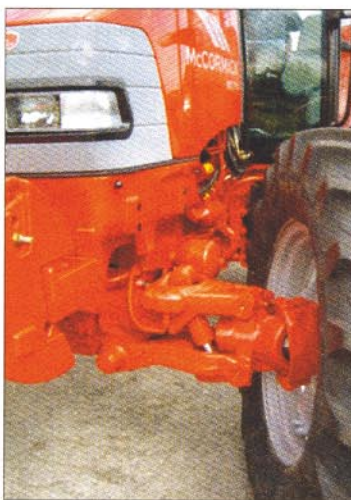
Einzelradaufhängung: gefederte MC-Vorderachse
