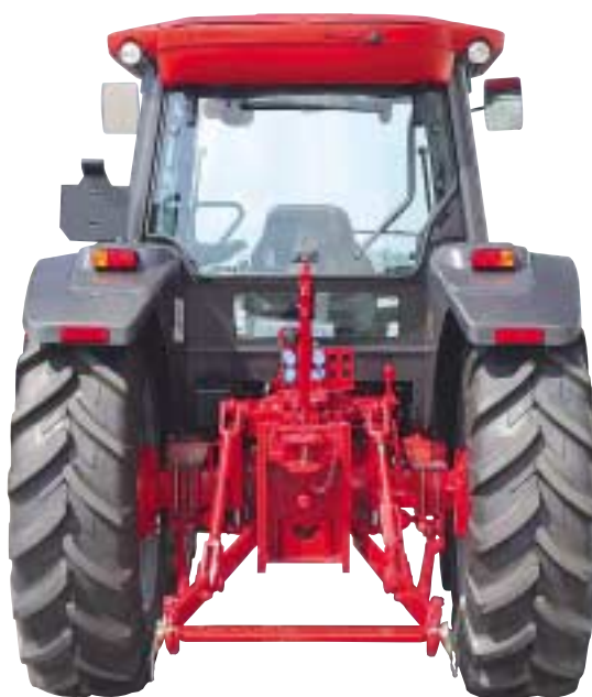
Im Heck sind bis zu vier Zusatzsteuergeräte möglich. In Österreich wird der C-Max serienmäßig mit zwei Zusatzhubzylindern angeboten.
