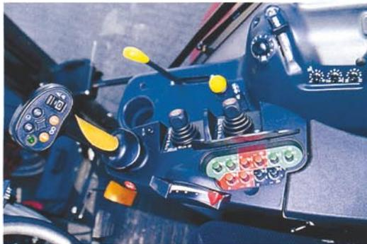
In der Vollausstattung mit Bedienarmlehne werden die acht Lastschaltstufen und die vier Gruppen einfach mit den orangenen Knöpfen im Multifunktionsgriff geschaltet. Die Einstellung der fünf elektrischen Ventile erfolgt mit den Knöpfen unter der Abdeckung.
