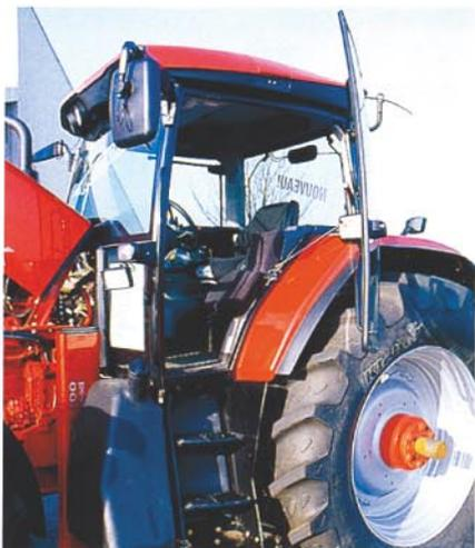
Die neue Kabine hat nur noch vier Pfosten und bietet einen geräumigen Aufstieg. Der Dieseltank fasst 350 l, die Motorhaube hat leider lose Seitenteile.
