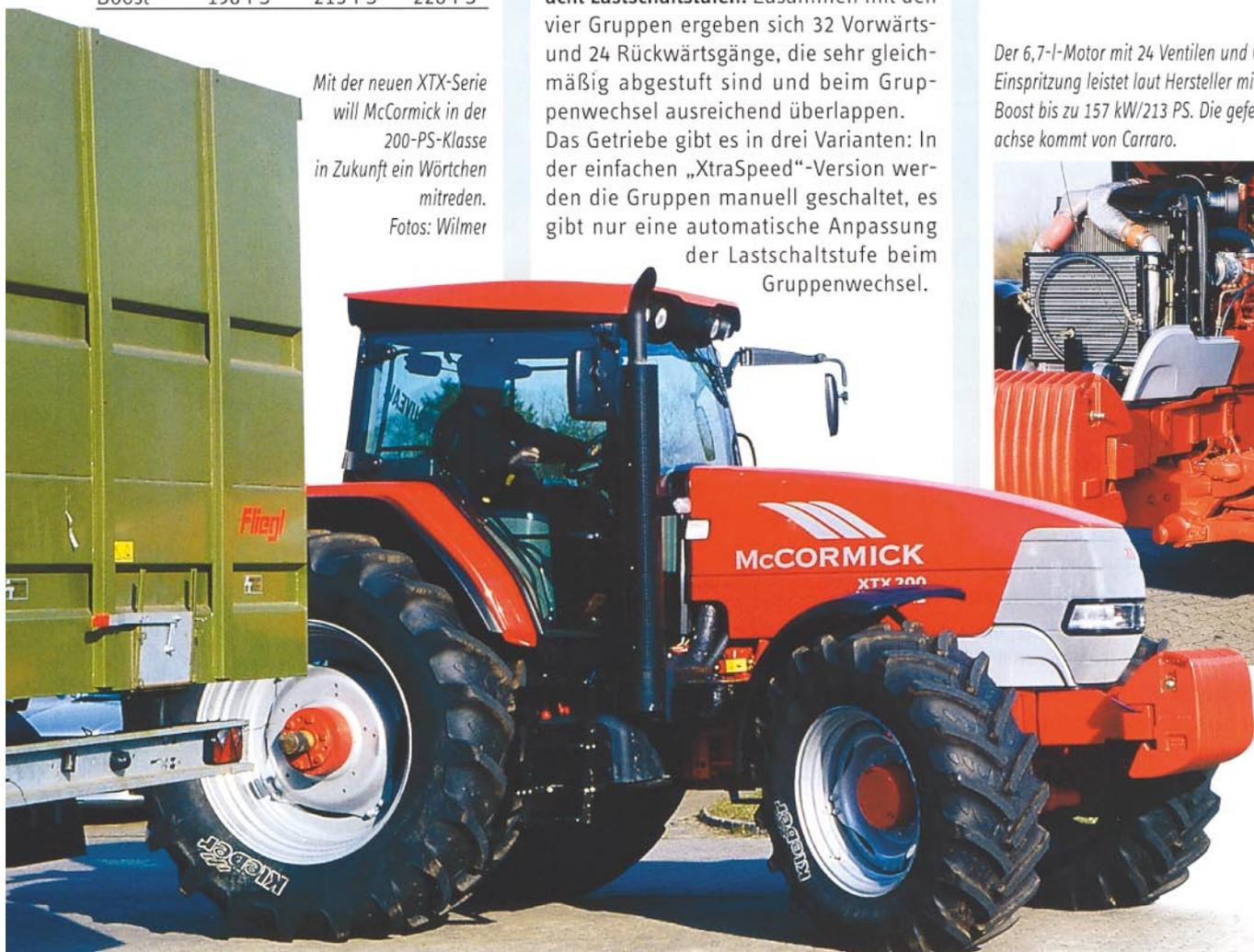
Das Hubwerk hebt laut McCormick fast 11 Tonnen. Der Zapfwellenstummel sitzt deutlich höher als beim MTX. Die Kabine ist hydraulisch gefedert (kleines Bild rechts).
