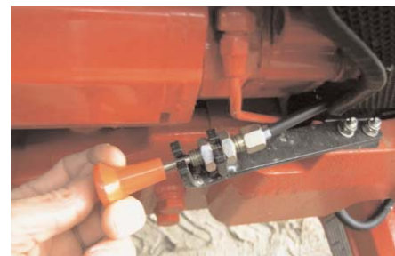
Die Motorhaube ist wie bei einem Pkw über einen Seilzug zu öffnen.
